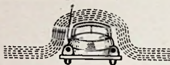
Bild 2. Die Horizontalpolarisierung der UKW-Rundfunkwellen wird an einer Metallkarosserie vertikal umgelenkt und ergibt damit eine Empfangsspannung in der normalen Autoantenne
