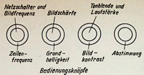
Bild 3. Die Anordnung der Bedienungsknöpfe Links: Bild 2. Die Eingangsschaltung mit dem Cascoden-Hf-Verstärker (linke ECC 81) und der Trioden-Mischstufe (rechte ECC 81)
